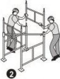
Os painéis paralelos devem ser colocados com as pontas de encaixe virados para cima. Para obter a distância entre painéis, encaixe a primeira trava.
